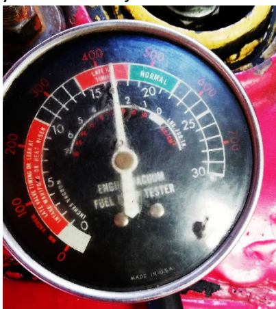
FIGURA 50.- comportamiento de la presión en el cilindro con aumento de 3mm de alzada y 15° de trabajo
