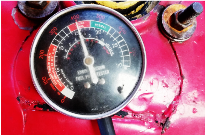
FIGURA 48.- medida de vacío con calibración estándar del motor
