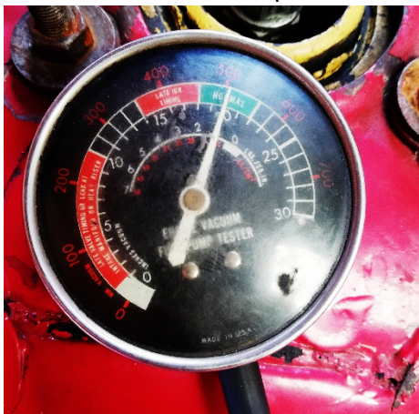
FIGURA 53.- medida de vacío al atrasar la barra de levas 2,5°
