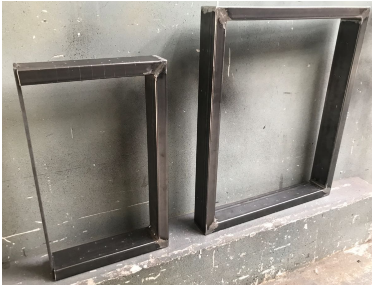
Figura 28 Bastidor equipo CNC. Tubo rectangular 60x30x1.5
