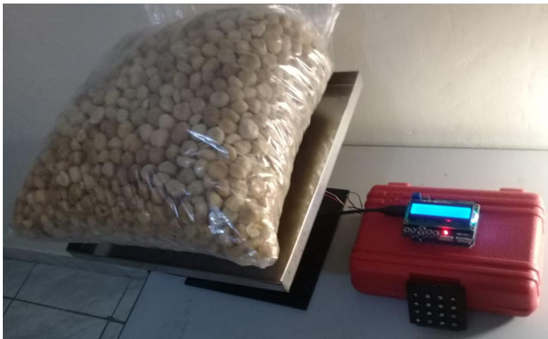
Gráfico 2. Forma final del sistema automático de optimización para inventariado de nuez de macadamia.
