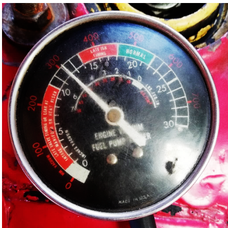
FIGURA 55.- medida de vacío al atrasar 10° la barra de levas
