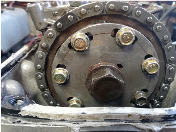
FIGURA 49.- elaboración de "ojos Chinos" sobre la polea de la barra de levas
