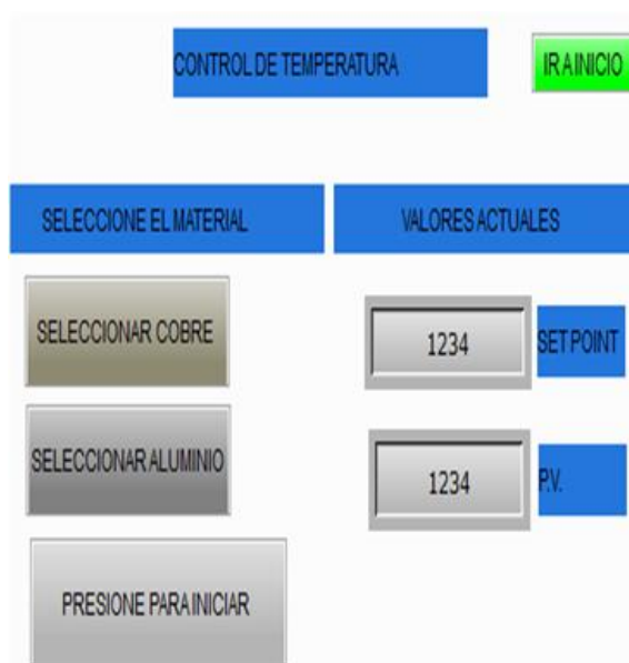
Figura 10. Pantalla de Menú de Fundición de la HMI.
