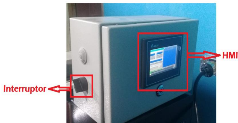
Figura 3. Gabinete de control.
