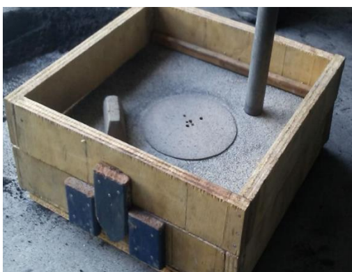
Figura 7. Molde listo para recibir el material fundido.
